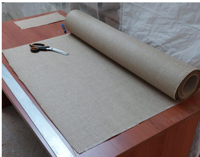
Slika 27. Tkana lanena vlakna u roli [Izvor: Autor]
