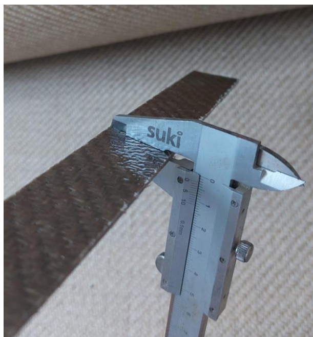
Slika 33. Konačna debljina epruvete [Izvor: Autor]
