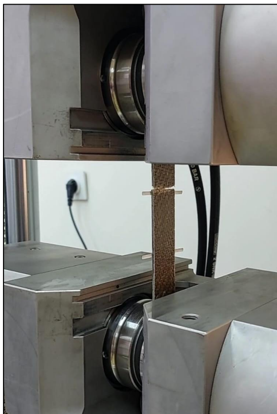
Slika 41. Puknuće epruvete pri ispitivanju [Izvor: Autor]
