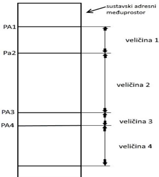
**Slika 12.** smještanje programa uz dinamično raspoređivanje radnog spremnika
