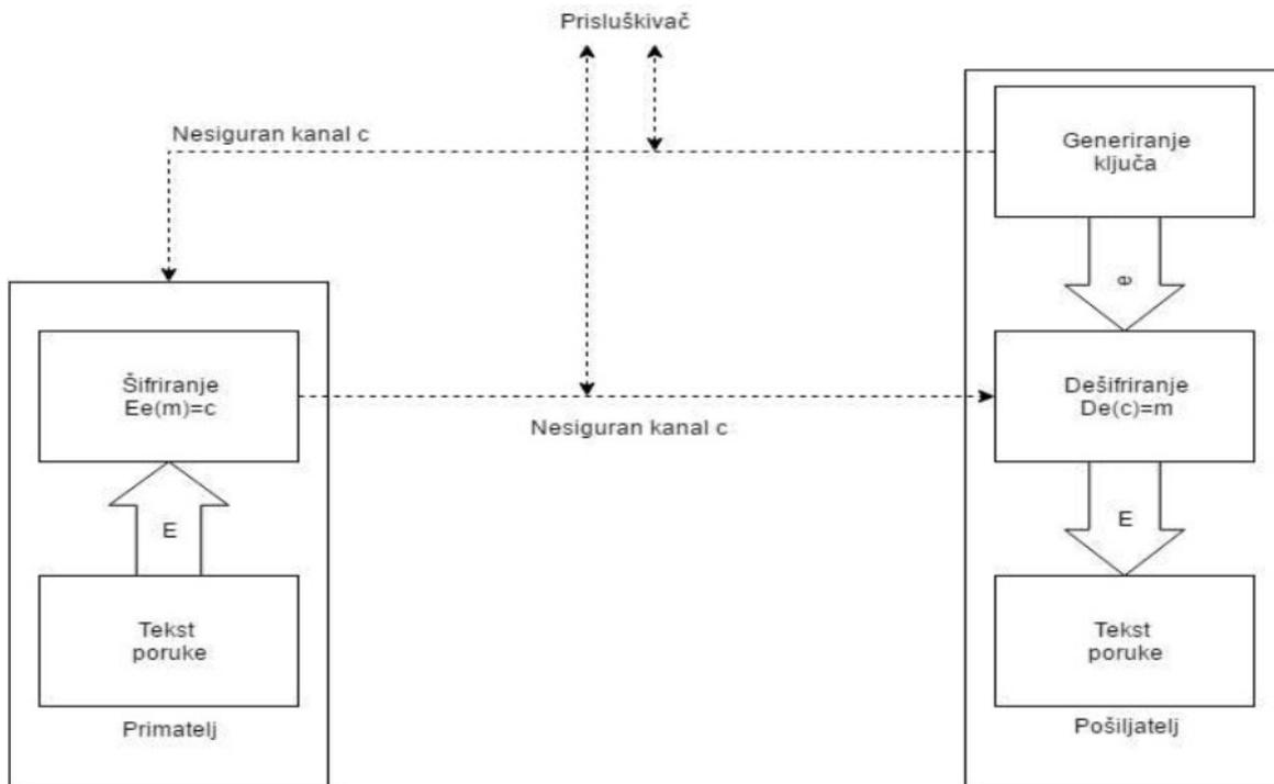
Slika 10: Shematski prikaz prijenosa poruke asimetričnim algoritmom s javnim ključem
