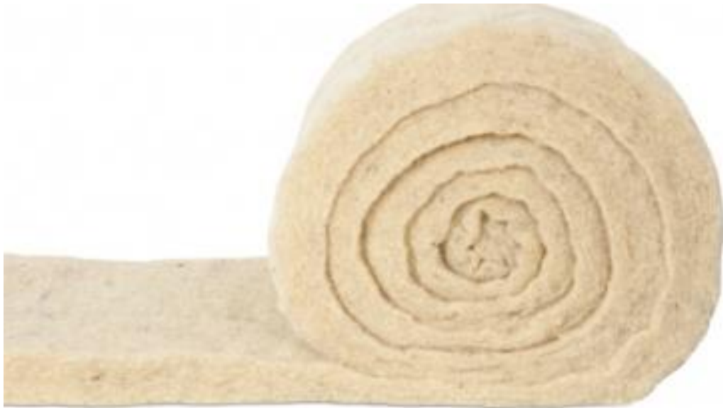
Slika 28: Ovčja vuna kao termo izolator
