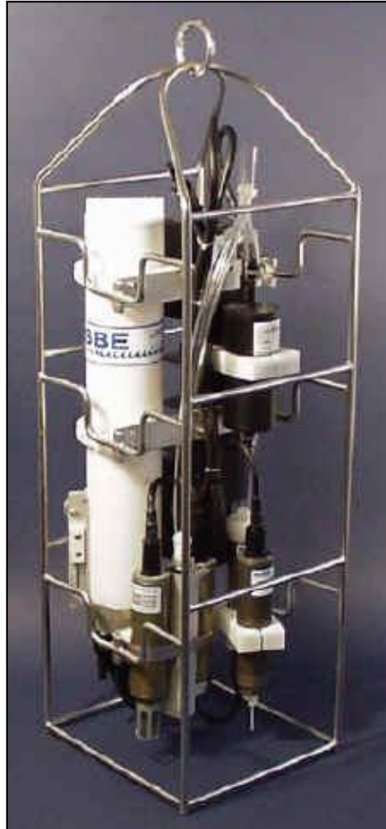
Slika 8. CTD sonda (engl. Conductivity, Temperature, Depth ) koja se koristi za mjerenje osnovnih hidrografskih parametara.
