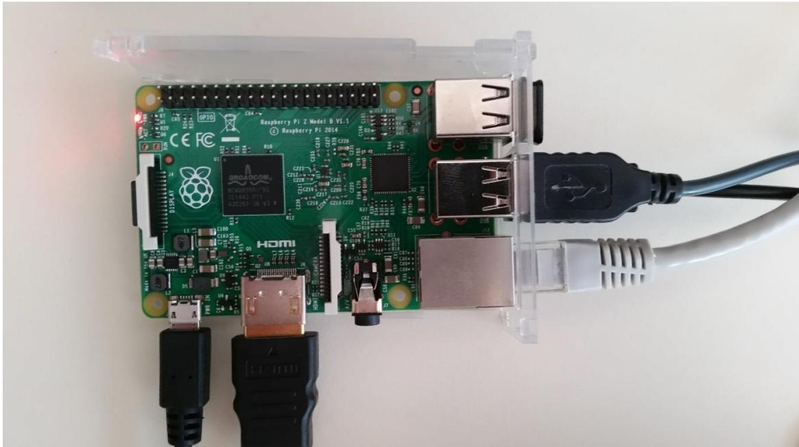
Slika 3. RPi 2 sa priključenim svim perifernim jedinicama, Ethernet kabelom i napajanjem.
