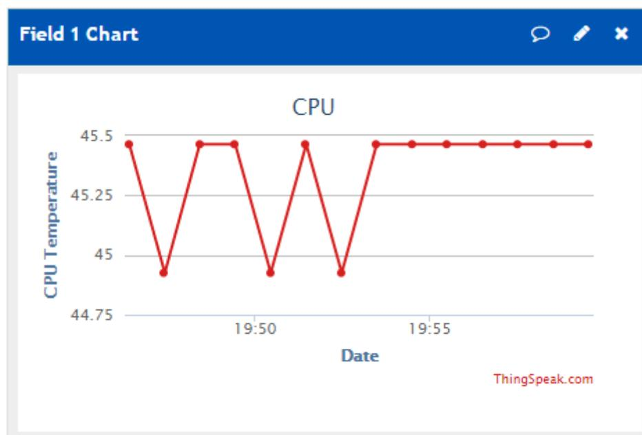
Slika 13. Prikaz temperature procesora na ThingSpeak kanalu.
