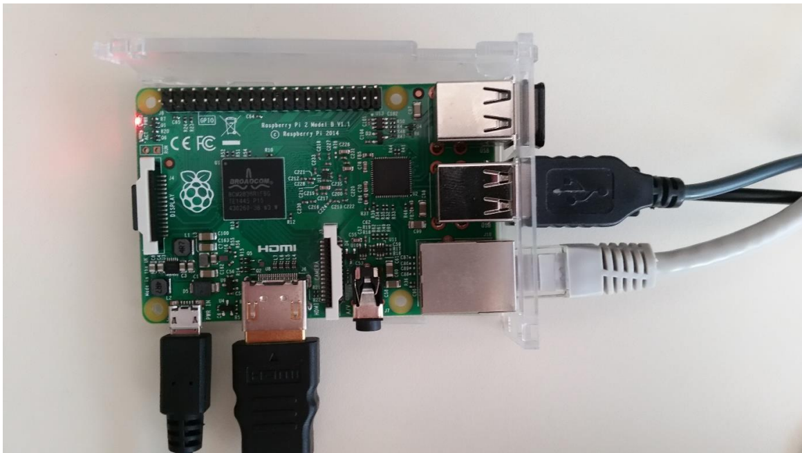
Slika 3. RPi 2 sa priključenim svim perifernim jedinicama, Ethernet kabelom i napajanjem.
