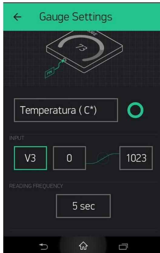
Slika 17. Dodavanje Gauge widgeta Temperatura na Virtualni Pin 3.
