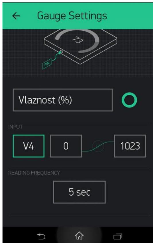
Slika 18. Dodavanje Gauge widgeta Vlaznost na Virtualni Pin 4
