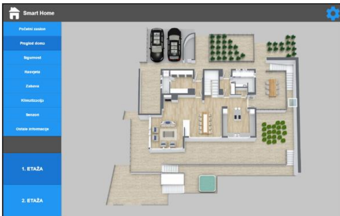
Slika 8. Prikaz načina kontroliranja prve etaže pametne kuće.
