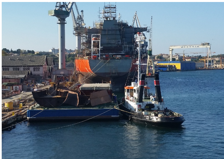
Slika br. 4 Sekcije Gradnje 732 na barži spremne za tegalj iz Pule u Rijeku
