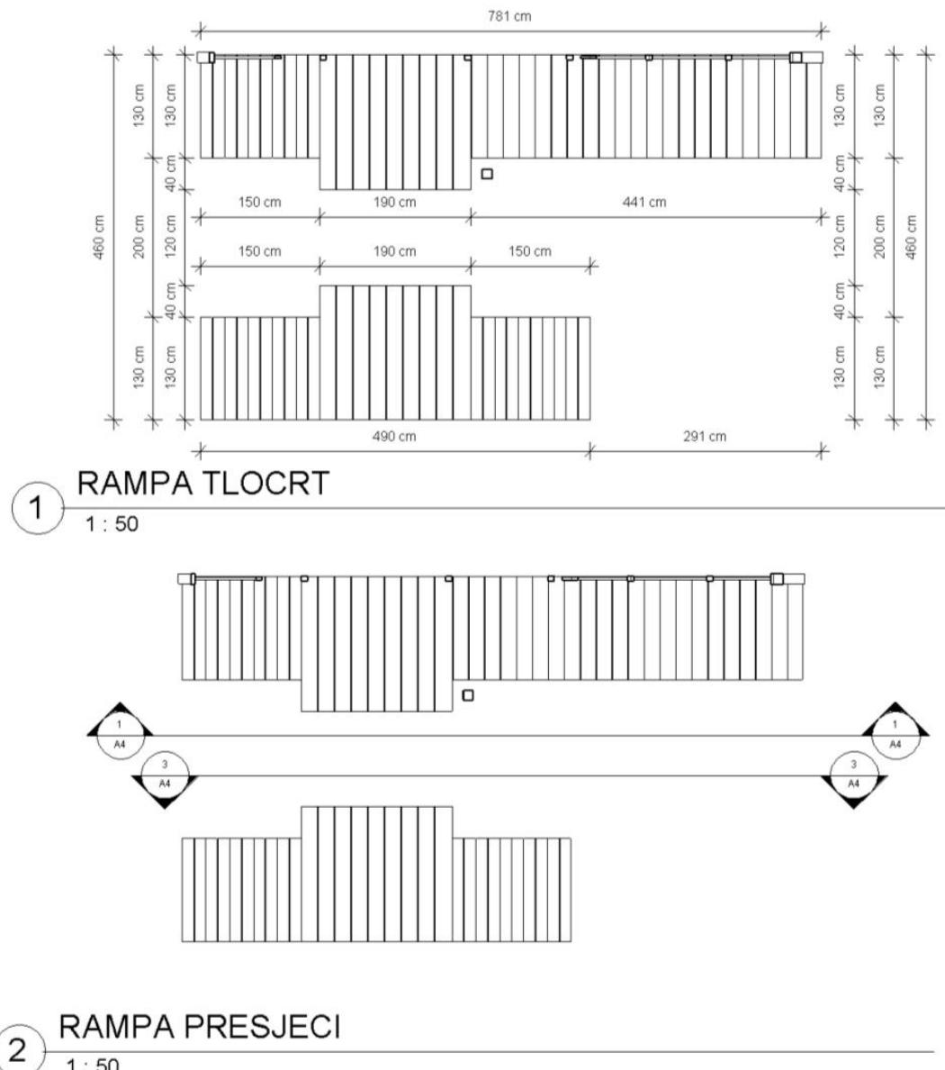
Slika 8. Tlocrt i presjeci za pravilno postavljanje rampe za uzjahivanje<sup>12</sup>
