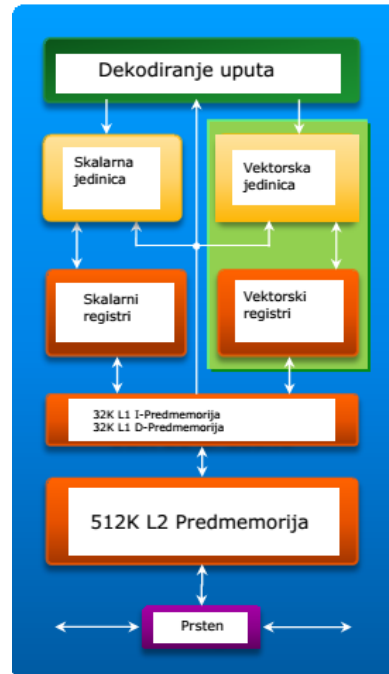
Slika 5. Arhitektura jezgre Xeon Phi procesora
