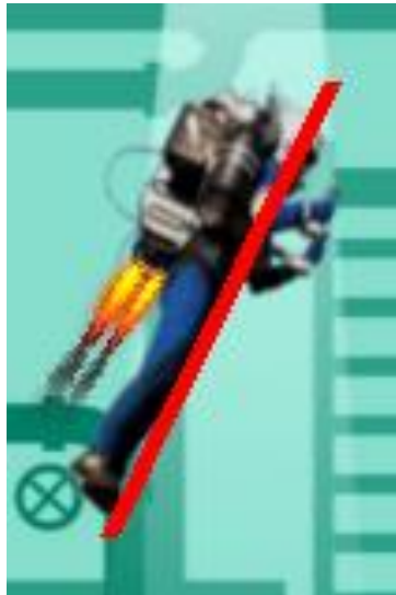
SLIKA 38: PRIKAZ ZAMIŠLJENE LINIJE ZA KOJU SE PROVJERAVA KOLIZIJA
