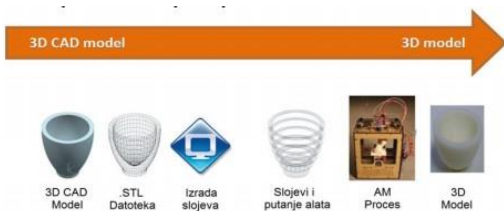
Slika 6. Proces izrade 3D modela (prototipa) (Šimunić, et. al., 2013).
