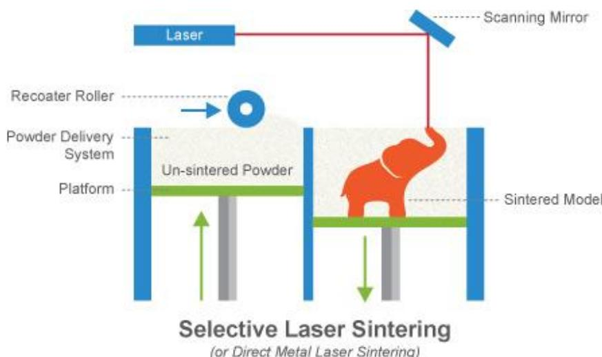
Slika 8. Izrada Selektivnim laserskim sinteriranjem (PrintSpace 3D, 2016).
