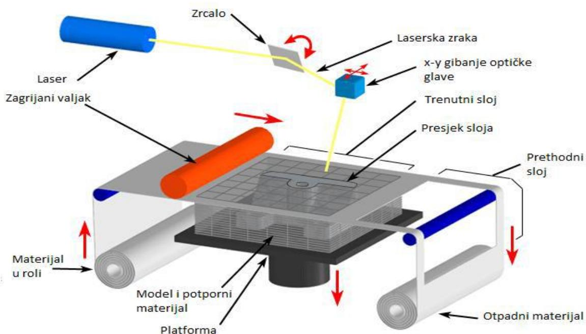
Slika 11. Izrada Laminiranom objektnom proizvodnjom (Horvat, 2016).
