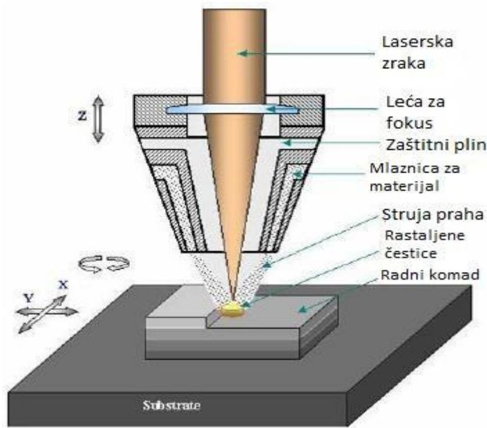
Slika 12. Izrada izravnim taloženjem metala laserom (Horvat, 2016).
