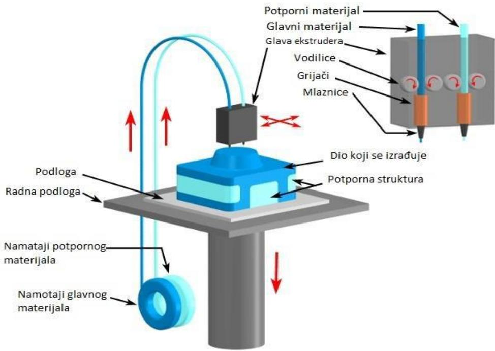
Slika 10. Izrada nanošenjem rastopljenog materijala (FDM) (Horvat, 2016).
