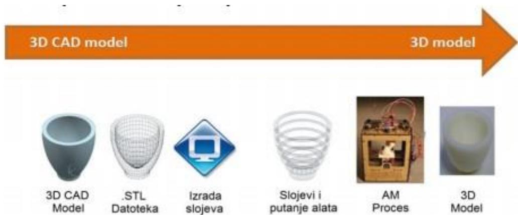
Slika 6. Proces izrade 3D modela (prototipa) (Šimunić, et. al., 2013).
