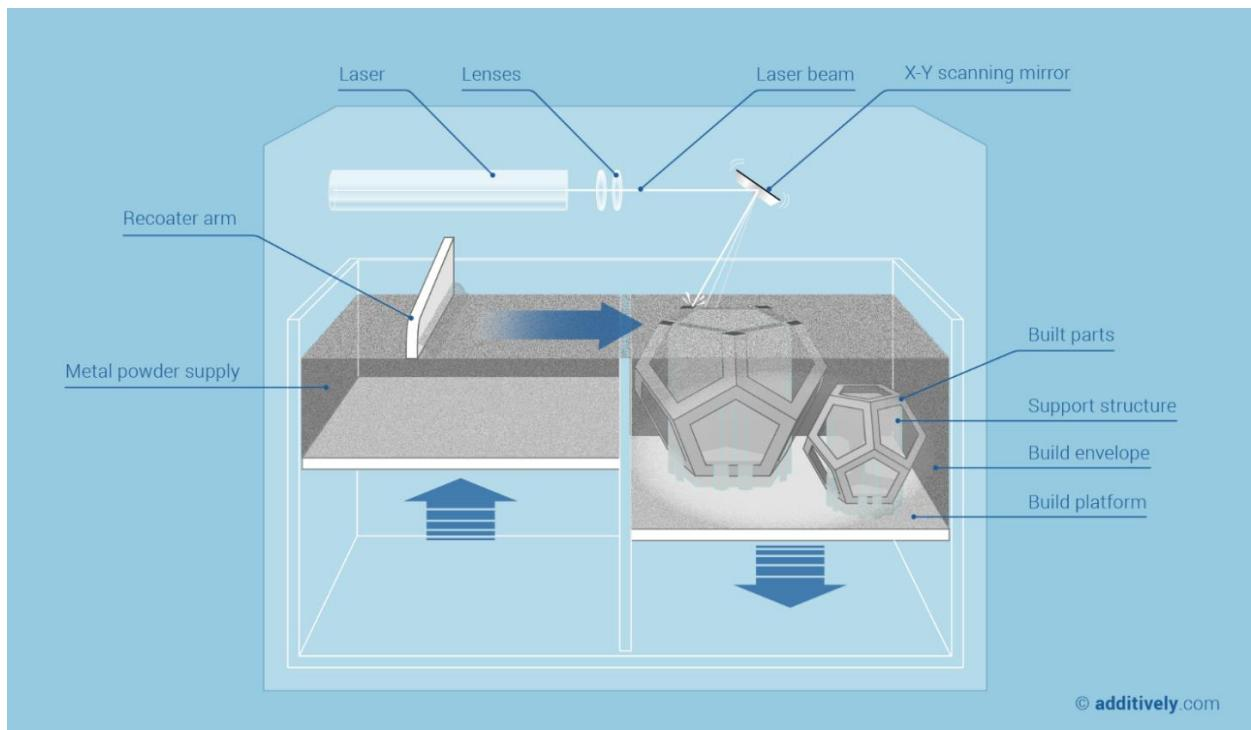
Slika 9. Izrada Direktnim laserskim sinteriranjem metala (Additively, n.d.).
