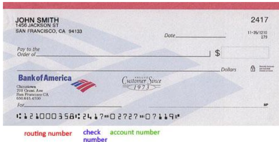
Slika 23. Ček iz američke banke. Na dnu se nalazi broj ispisan u OCR – A fontu. Izvor: http://www.how-ocr-works.com/history/history.html
