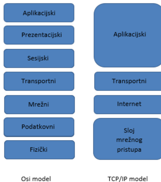
Slika 1: Prikaz slojeva OSI referentnog modela i TCP/IP modela te protokola u TCP/IP modelu
