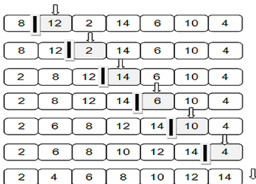
Slika 5. Prikaz rada algoritma jednostavnog sortiranja umetanjem
