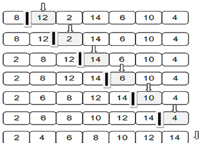
Slika 5. Prikaz rada algoritma jednostavnog sortiranja umetanjem
