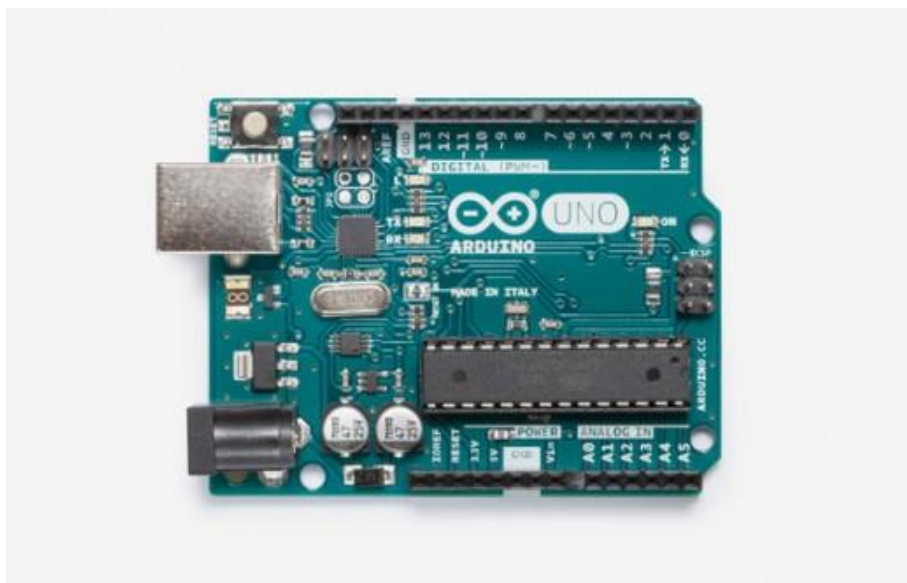
Slika 2: Arduino Uno model (izvor: http://www.arduino.cc )
