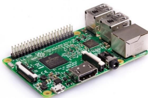
Slika 1: Raspberry Pi (izvor: http://www.raspberrypi.org )
