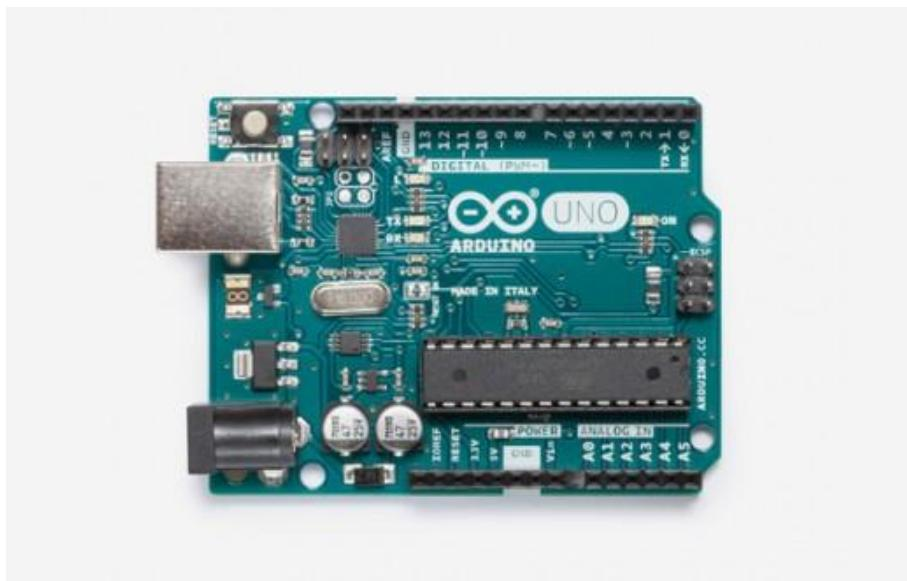
Slika 2: Arduino Uno model (izvor: <http://www.arduino.cc>)
