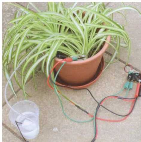
Slika 11: Automatsko navodnjavanje (izvor: Hajdinjak, N., Primjeri integracije microbita u nastavu s različitim međupredmetnim sadržajima )
