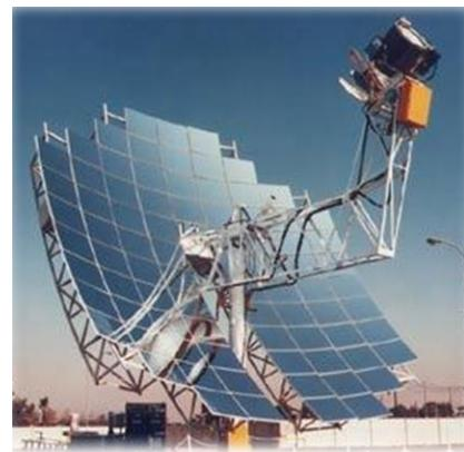
*Slika 5: Solarni parabolički tanjur*
