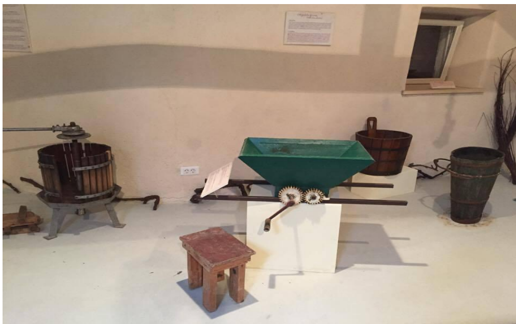
Fotografija 10. Muljače za prešanje grožđa (fotografirala N. Rašin, 2017. ©)
