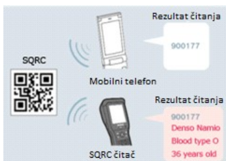
Slika 17. Prikaz čitanja SQRC koda 28
