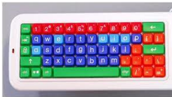
Slika 14. Primjer tipkovnice asistivne tehnologije
