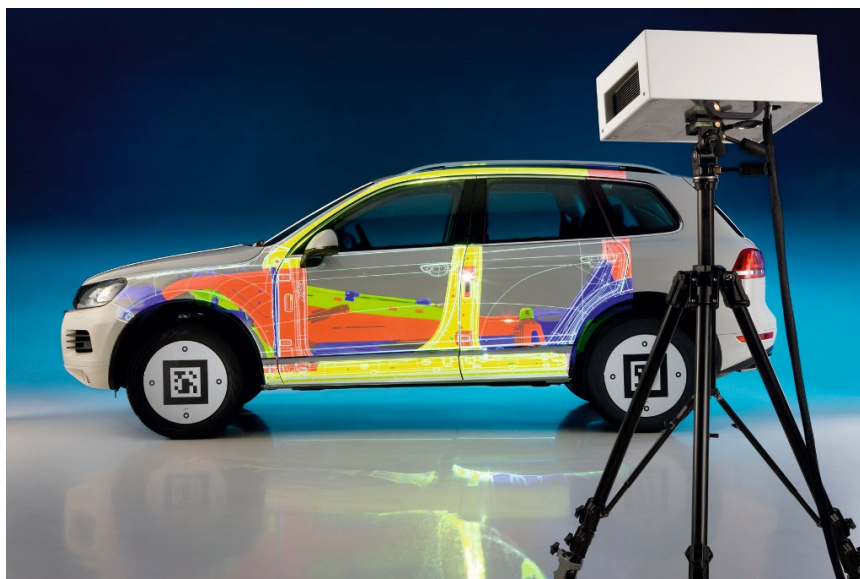
Slika 7. Primjer projekcijske proširene stvarnosti na VW automobilu
