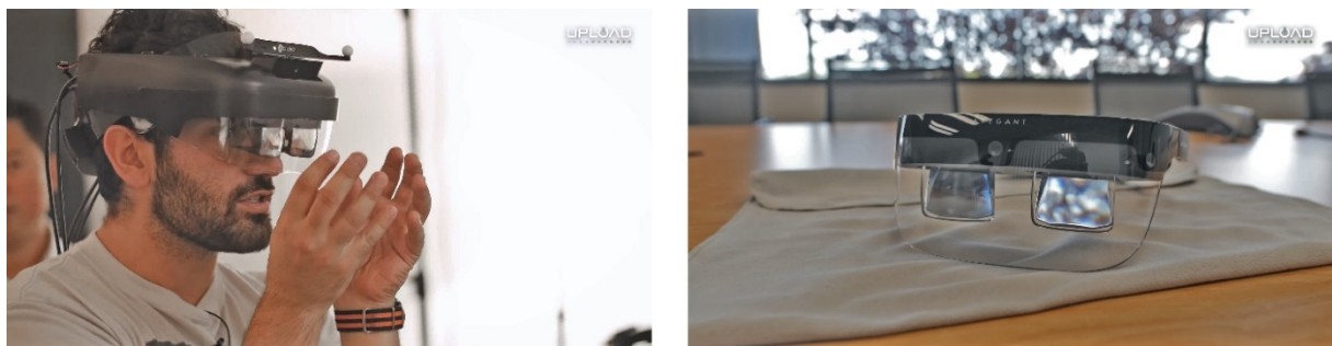
Slika 39. Prototip Avegant HMD uređaja sa Light Field tehnologijom (lijevo) i planirani izgled finalnog prototipa HMD uređaja za developere (desno)
