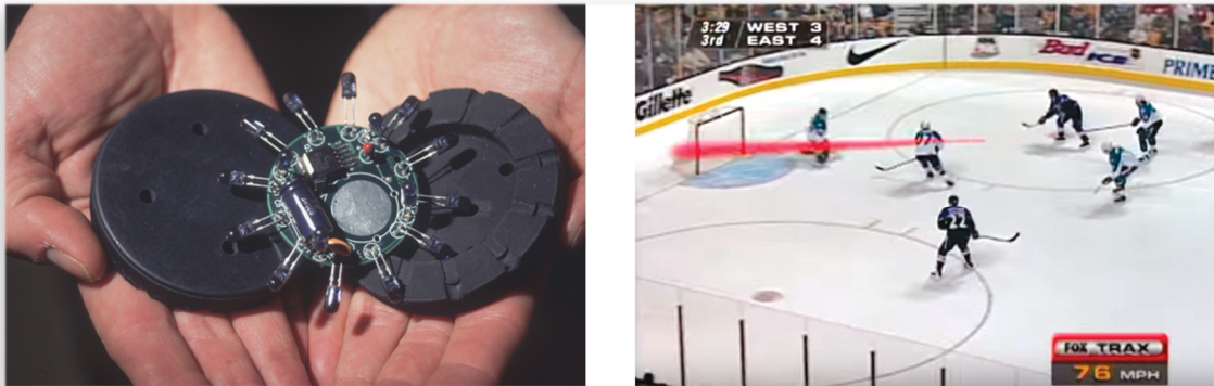
Slika 21. Hockey puck s integriranim odašiljačima i prikaz istog putem televizijskog prijenosa (Izvor: SportsBusiness Journal, 2017.)
