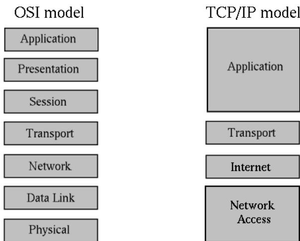
Slika 1. Prikaz slojeva OSI referentnog modela i TCP/IP modela
