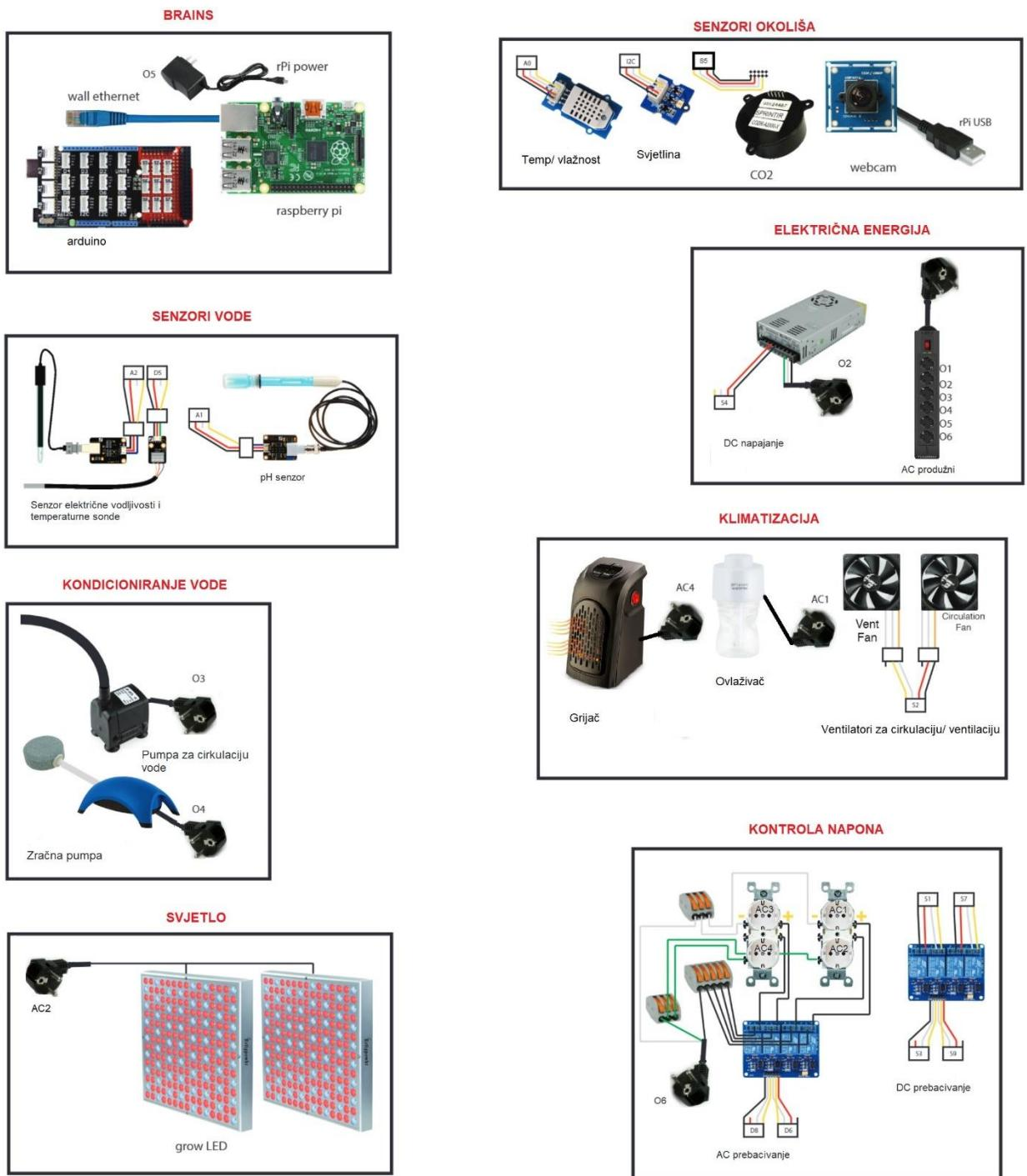
Slika 28. Uvećani shematski prikaz elektoničkih komponenata PFC-a
