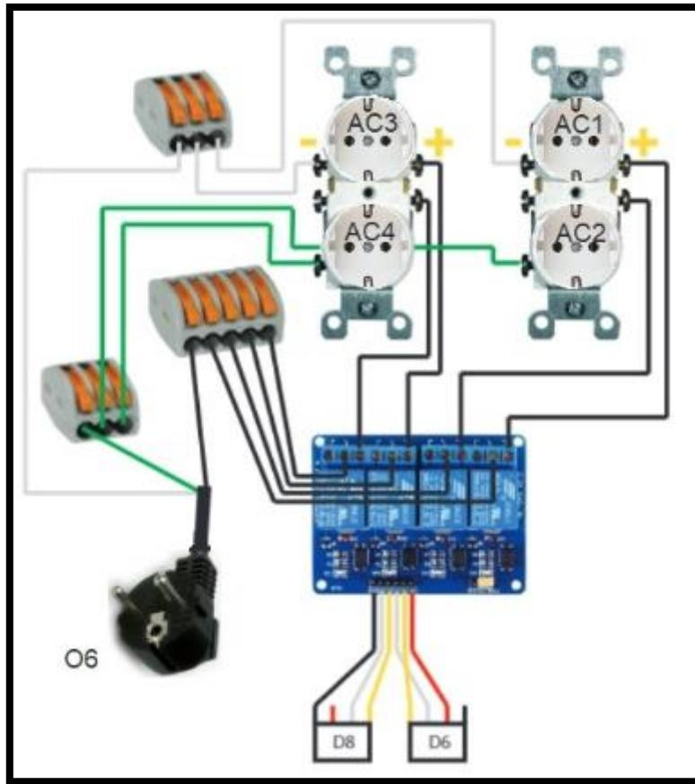
Slika 34. Shematski prikaz upravljačkog modula za izmjeničnu struju
