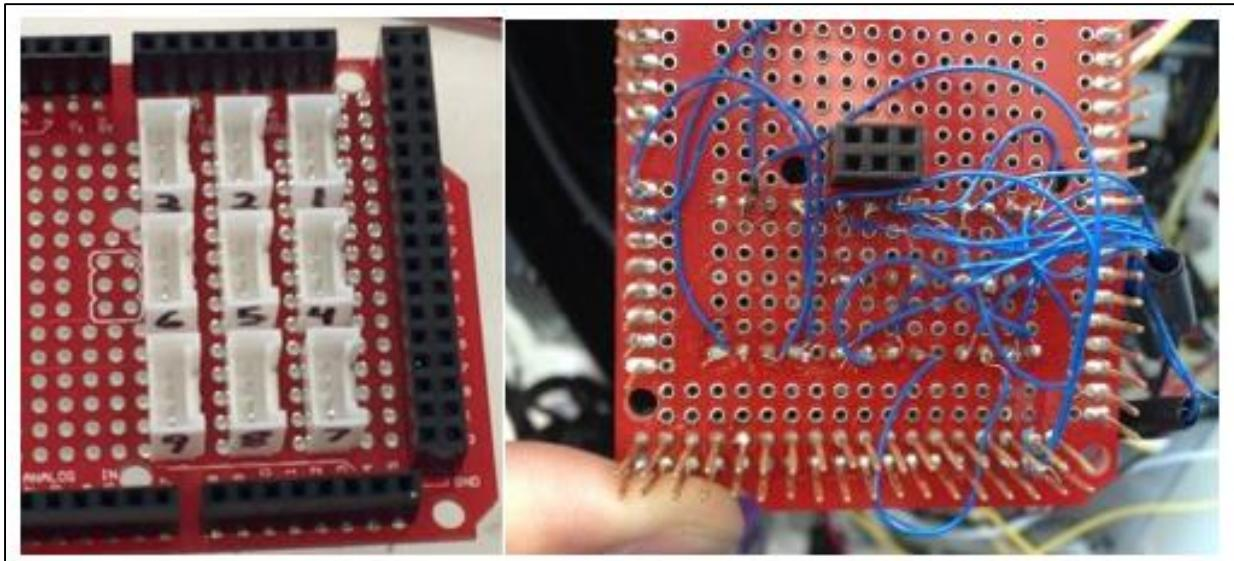
Slika 30. Protoshield pločica sa postavljenim grove konektorima
