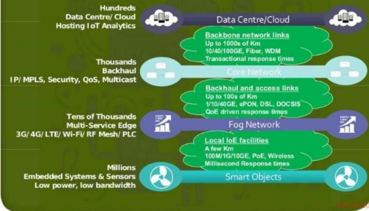
Slika 5. Osnovni koncept Fog Computing-a. [34]
