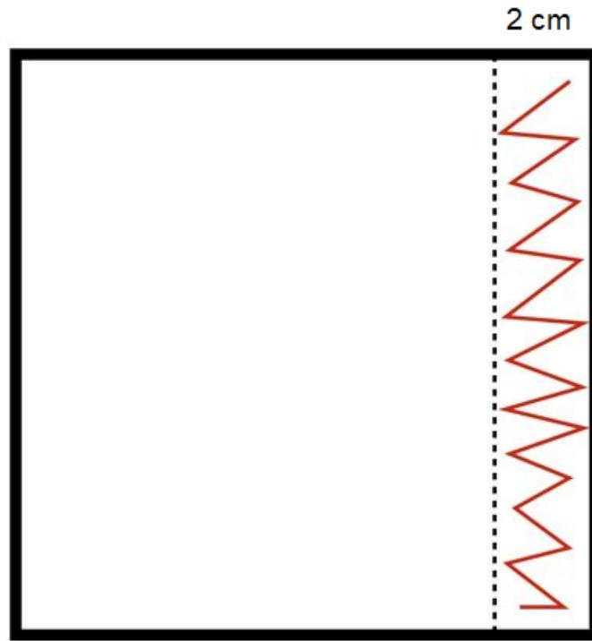
Slika 22. Prikaz ruba za lijepljenje izolacijske ploče [35]
