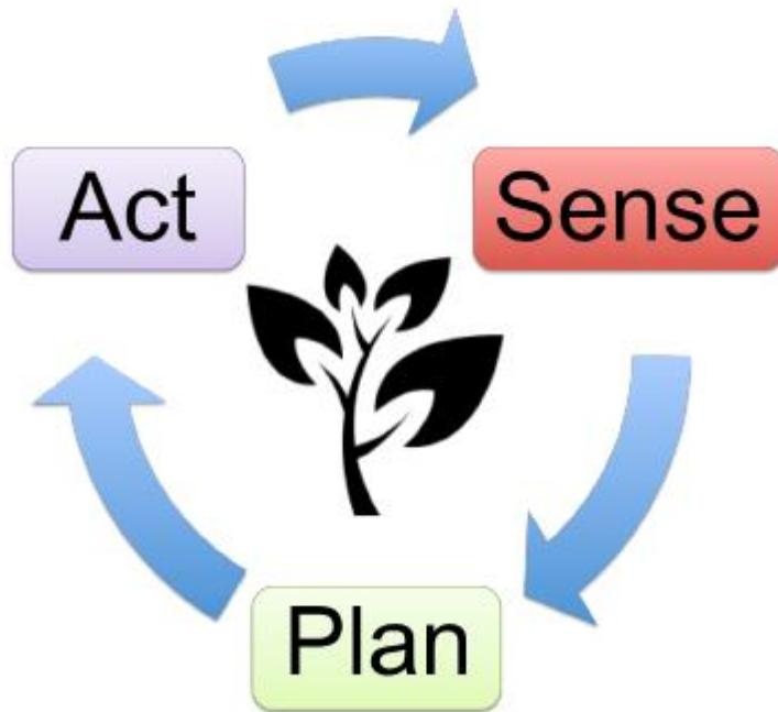
Slika. 6 Klasična petlja s povratnom vezom koja se intenzivno koristi u istraživanju robotske opreme. Ova petlja sastoji se od tri glavne faze (Sense, Plan, Act), koji u kombinaciji s modernim poljoprivrednim uređajima s kontroliranim okolišem dopuštaju tretiranje biljaka kao "robotskih" agenata.
