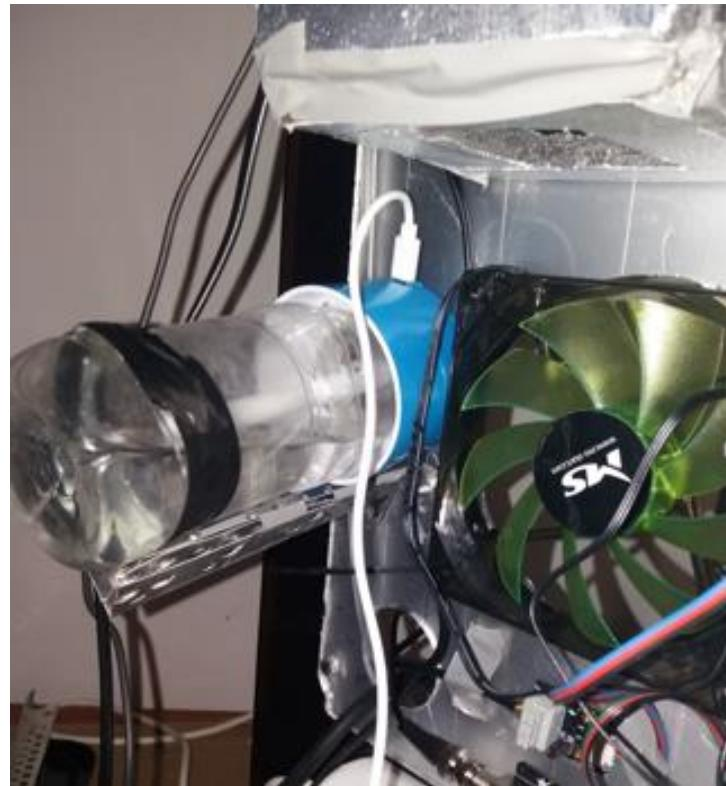
Slika 37. Montiran ovlaživač zraka
