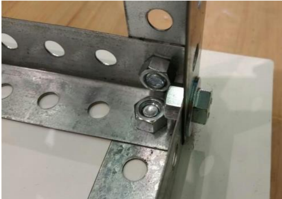
Slika 18. Učvršćena sjecišta kuteva glavnog okvira
