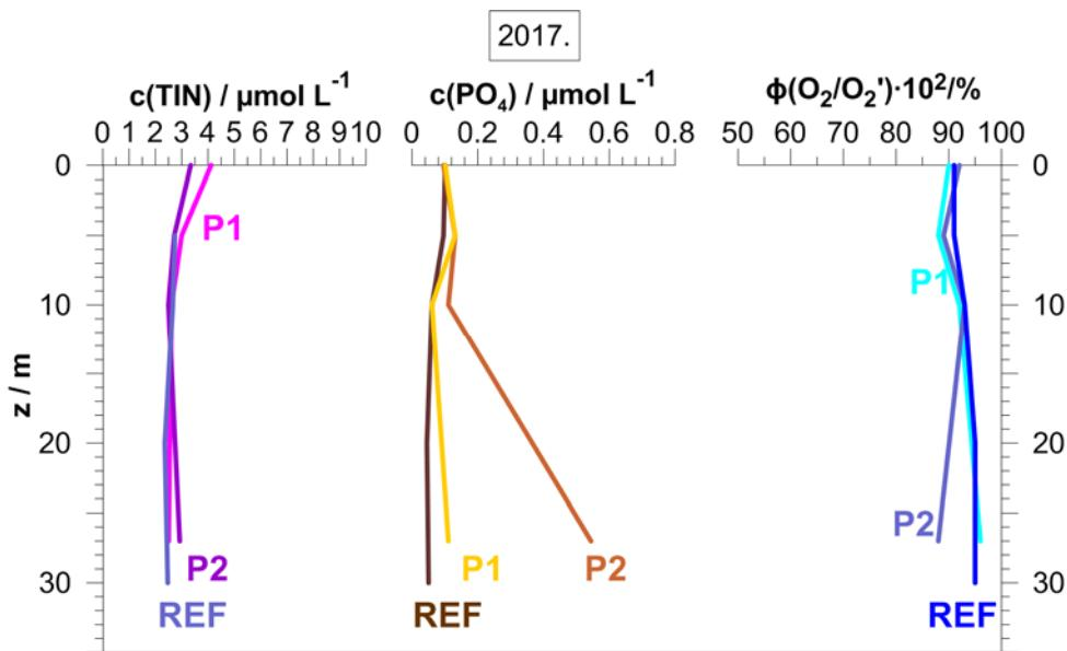
**Slika 3.1.2.** Vertikalni profili koncentracije ukupnog anorganskog dušika (TIN-a) i ortofosfata (PO<sub>4</sub>) te udjela zasićenja kisikom ( $(\phi(O_2/O_2'))$ ) u vodenom stupcu istraživanih postaja u studenom 2017. godine.
