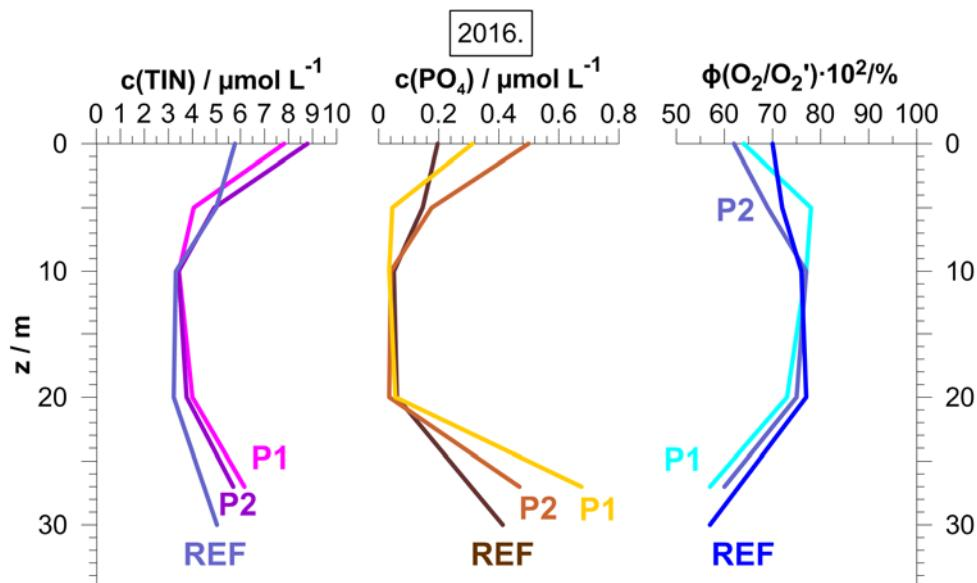
**Slika 3.1.1.** Vertikalni profili koncentracije ukupnog anorganskog dušika (TIN-a) i ortofosfata (PO<sub>4</sub>) te udjela zasićenja kisikom ( $(\phi(O_2/O_2'))$ ) u vodenom stupcu istraživanih postaja u studenom 2016. godine.
