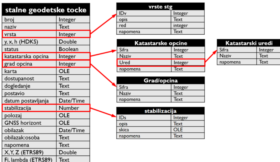
Slika 19 - Relacijski model baze podataka stalnih geodetskih točaka
