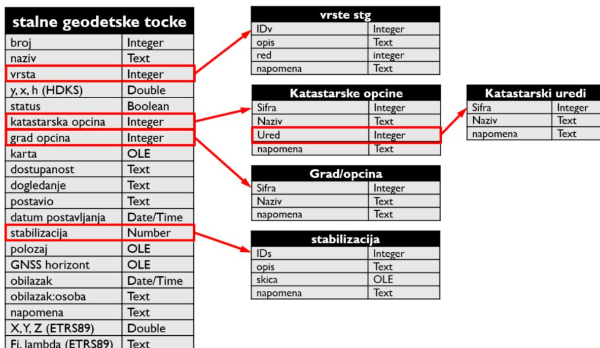
Slika 19 - Relacijski model baze podataka stalnih geodetskih točaka
