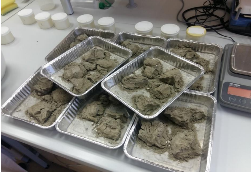
Slika 5. Osušeni sediment izvađen iz peći
