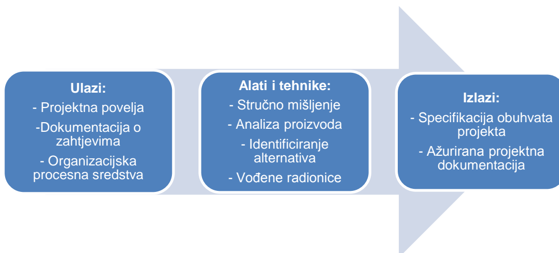
Shema 1: Ulazi, alati i tehnike te izlazi za proces definiranja obuhvata projekta.
