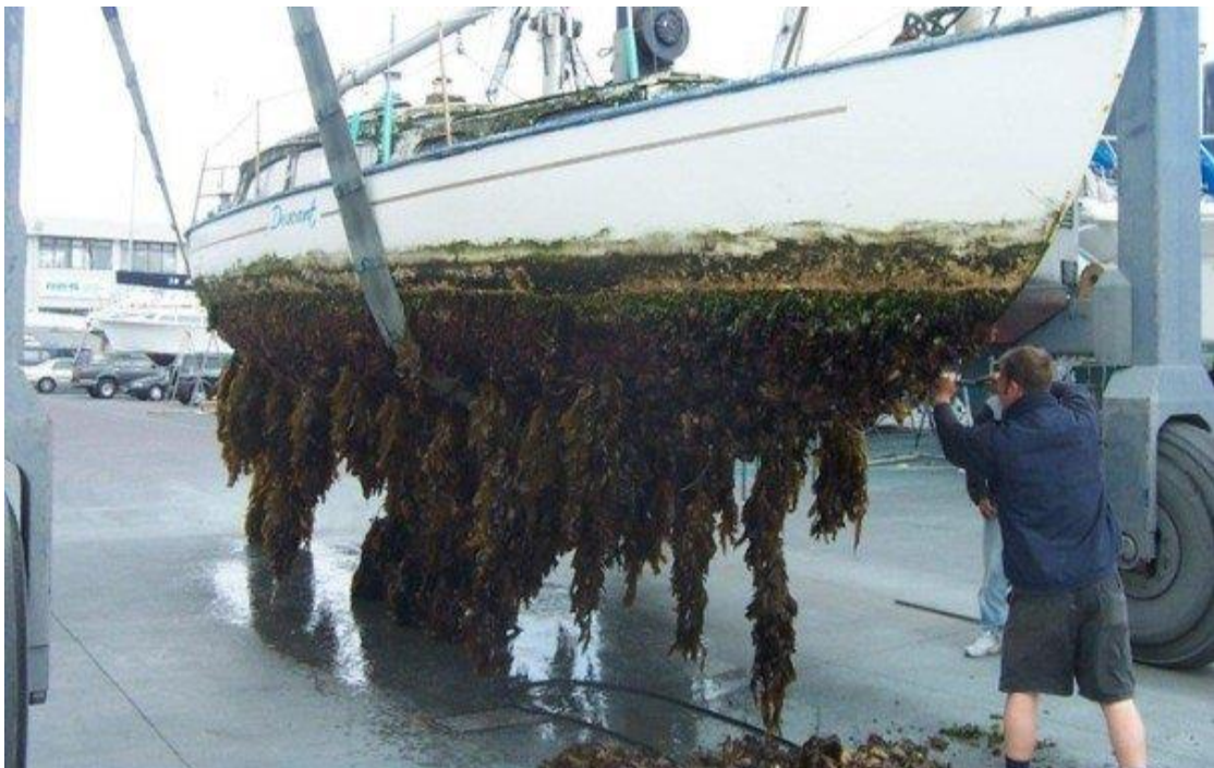
Slika 1. Obraštaj na brodu (izvor: https://smallboater.com/biofouling-guide/ )
