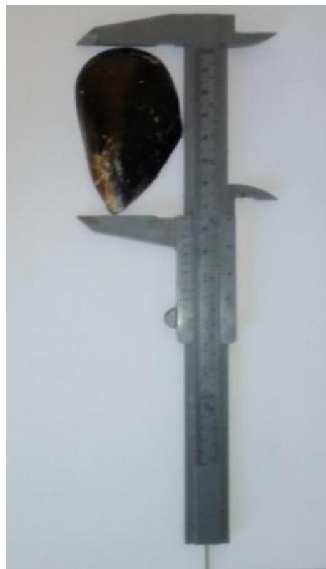
**Slika 4.** Mjerenje dužine ljuštura digitalnom pomičnom mjerkom
