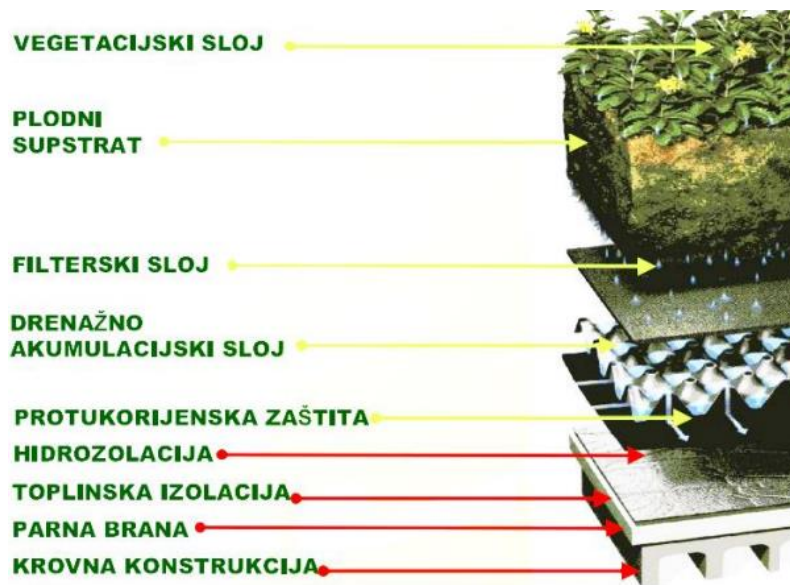
Slika 9. Osnovne komponente zelenog krova
