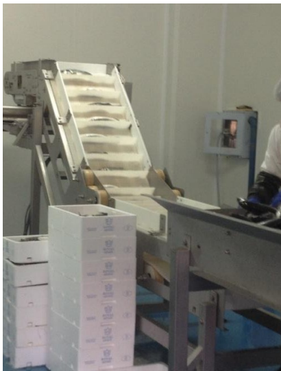
Slika 17. Sortiranje riba prema pecaturi (Izvor: Novosel Brigita)
