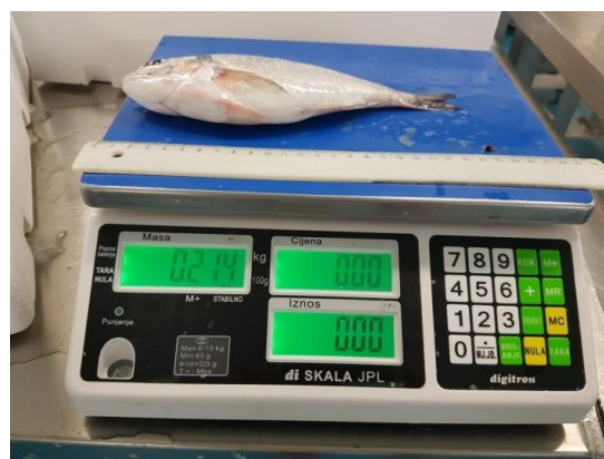
Slika 26. Vaganje mase ribe (Izvor: Novosel Brigita)
