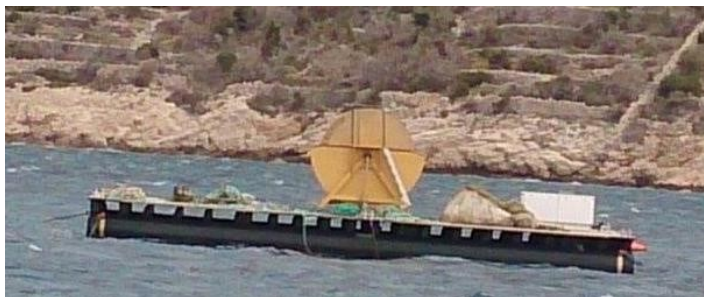
Slika 14. Bubanji za pranje mreža (Izvor: Novosel Brigita)
