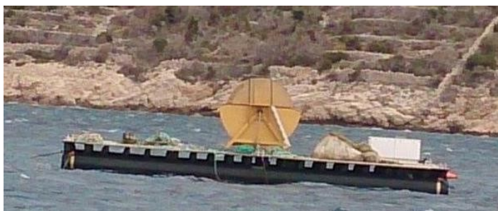
Slika 14. Bubanji za pranje mreža (Izvor: Novosel Brigita)
