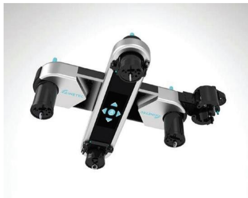
Slika 13. Mobilni robot za ispitivanje cijevi FORERUNNER tvrtke INETEC (izvor: http://www.infotrend.hr/userfiles/Image/casopis/200/Infotrend_200_z_a_web-2-045.jpg )
