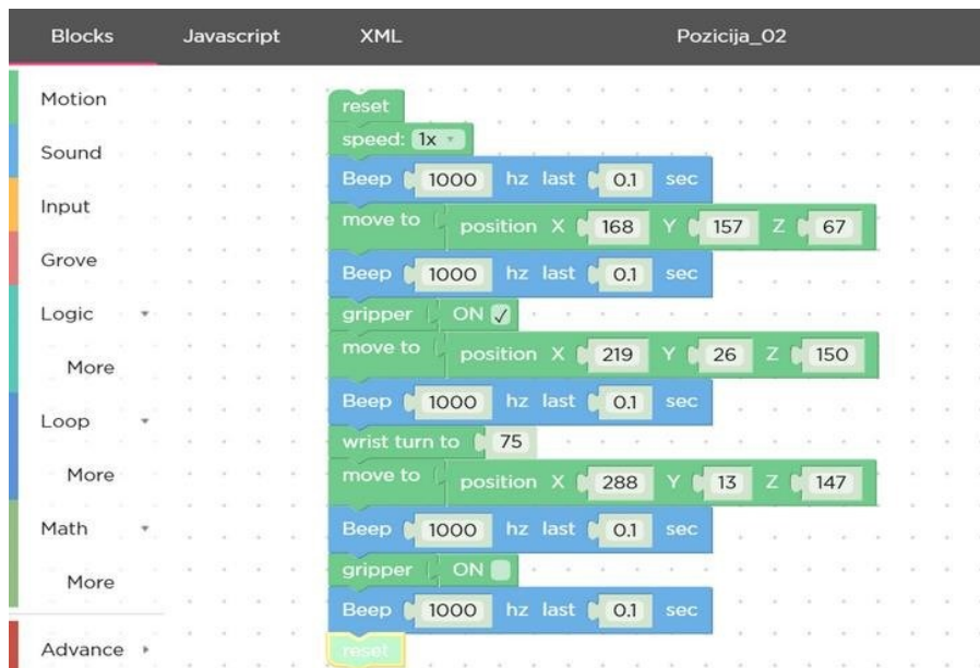
Slika 50. Prikaz programskih blokova
