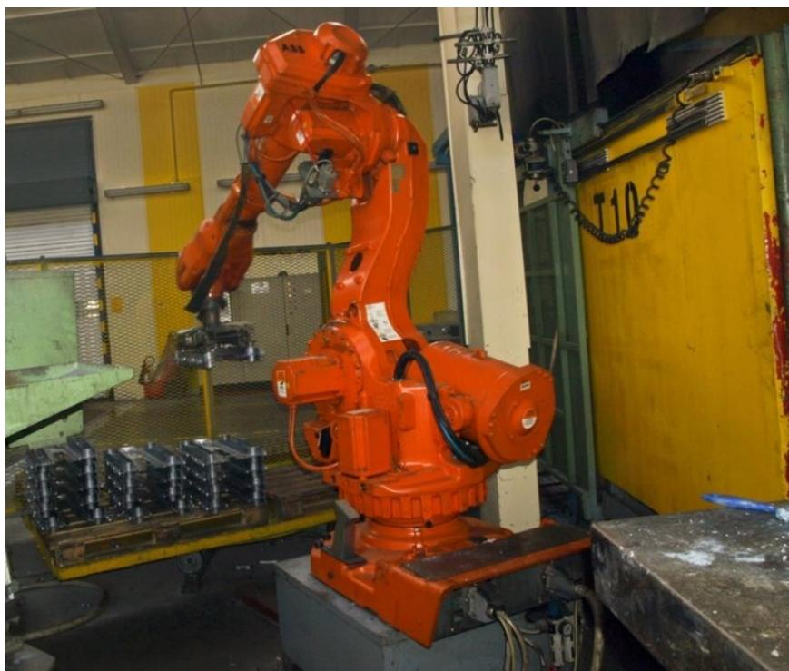
Slika 15. Robot na poslovima izvlačenja odjlevka tlačnog lijeva, Tvornica radijatora u Lipovici (izvor: [http://lipovica.hr/lib/plugins/thumb.php?src=upload\\_data/site\\_photos/web\\_006.jpg&w=1000&h=750&z=c=3](http://lipovica.hr/lib/plugins/thumb.php?src=upload_data/site_photos/web_006.jpg&w=1000&h=750&z=c=3))
