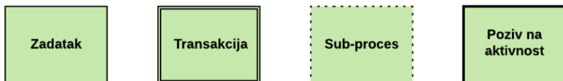
Slika 9. Zadatak (engl. Task ), transakcija (engl. Transaction ), sub-proces (engl. Event Sub-Process ), poziv na aktivnost (engl. Call Activity )
