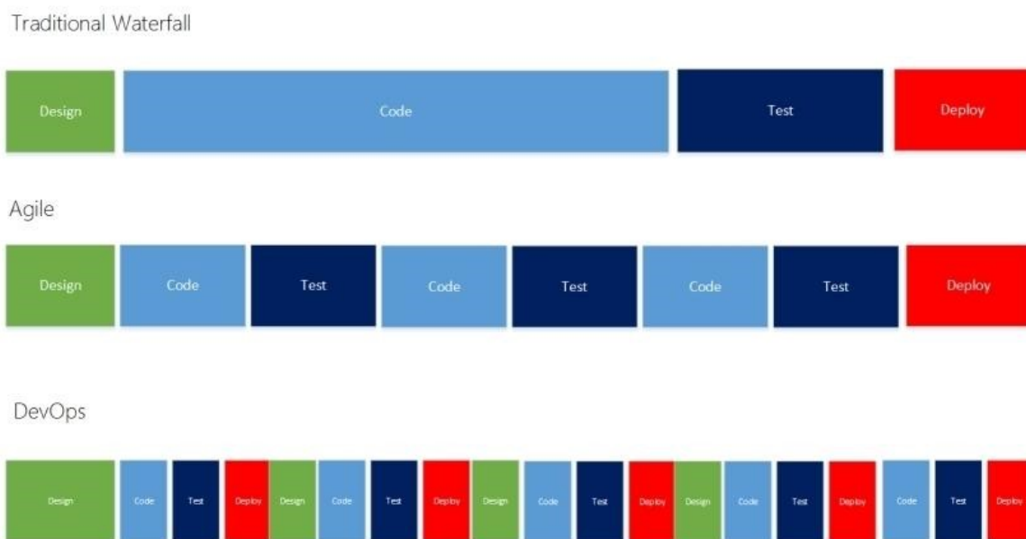
Slika 9. Prikazuje razliku između metoda u trajanju određenih stavki i broju ponavljanja istih.
