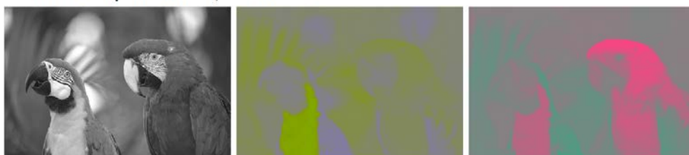
Slika 11. YCbCr komponente, izvor: http://www.bk.isy.liu.se/en/courses/tsbk06/material/
