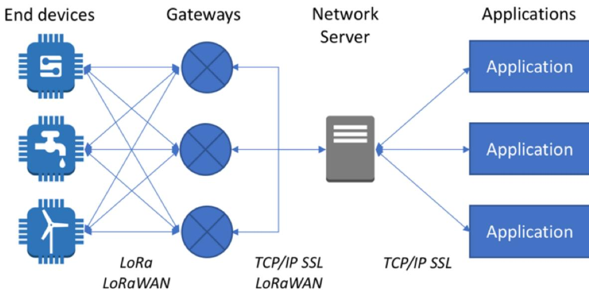
Slika 2. 9. Dijagram povezivanja LoRaWAN uređaja s Internetom
