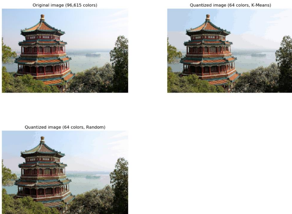
Slika 5. Usporedba fotografija prije i nakon kvatizacije
