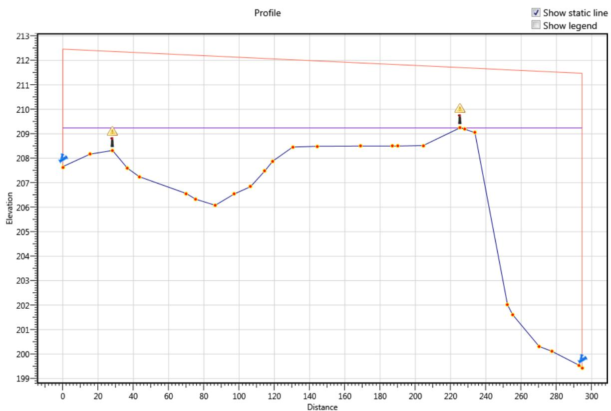
Prikaz se sastoji od uzdužnog profila cjevovoda (plava linija), hidrauličke gradijentne linije i statičke linije.
