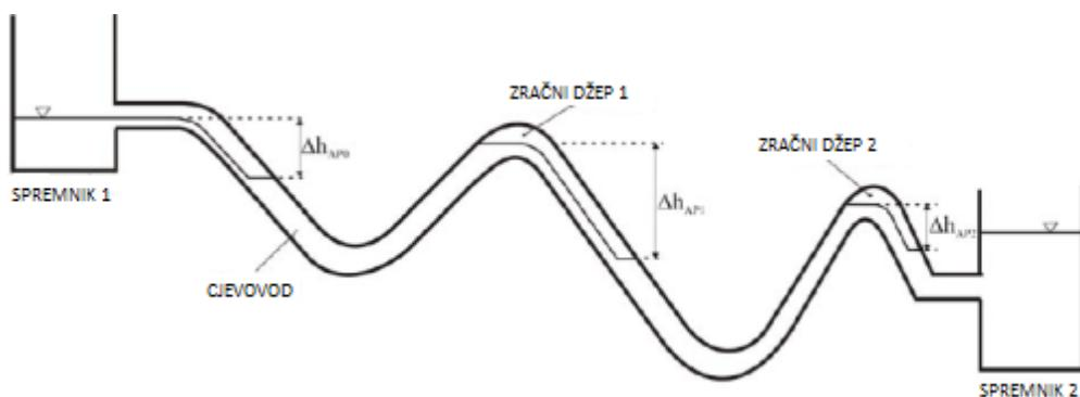
Slika 2.7. Zračni džepovi u tlačnom cjevovodu
