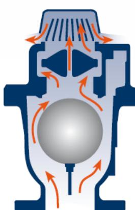
1. U fazi brzog punjenja cjevovoda vodom, zrak se potiskuje kroz zračni ventil, kreirajući diferencijalni tlak na otvoru zračnog ventila.
