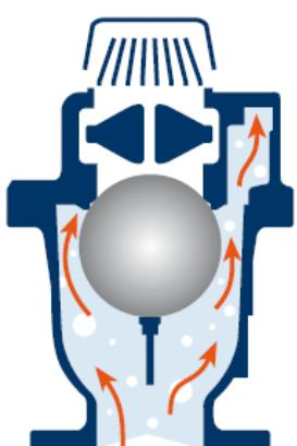
4. Kada voda dosegne plutajuću kuglu, kugla se podiže i zatvara otvor ventila, čime se završava ciklus ispuštanja zraka iz cjevovoda kroz zračni vakuumski non-slam ventil.
