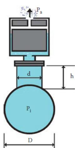
Tablica 3.2. Instalacija automatskog zračnog ventila
