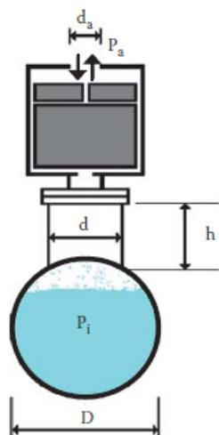
Tablica 3.3. Instalacija vakuumskog zračnog ventila
