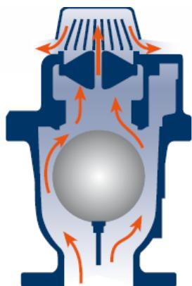
2. Kada diferencijalni tlak dosegne predodređenu razinu (obično se podešava na 0,02-0,03 bar) protu udarni (engl. non-slam) disk se zatvara.
