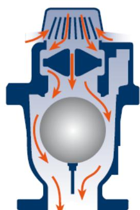
6. Ispuštanje vode iz cjevovoda uzrokuje pad vrijednosti internog tlaka sistema u odnosu na okolni atmosferski tlak, plutajuća kugla se spušta otvarajući otvor ventila za slobodan prolaz zraka u cjevovod.
