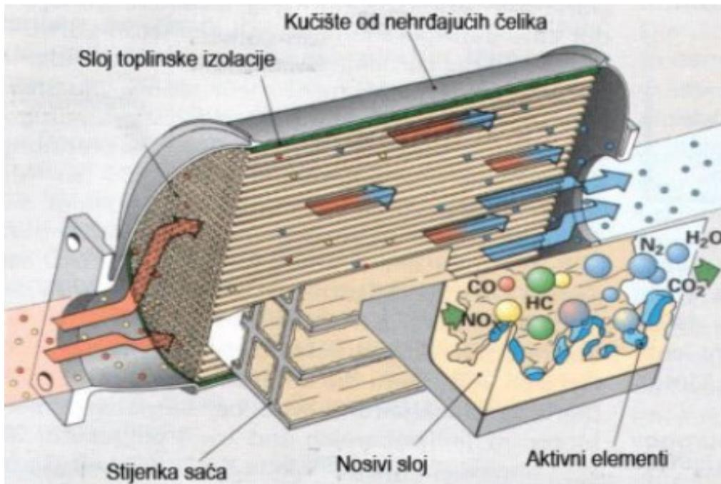
Slika 5. Presjek katalizatora
