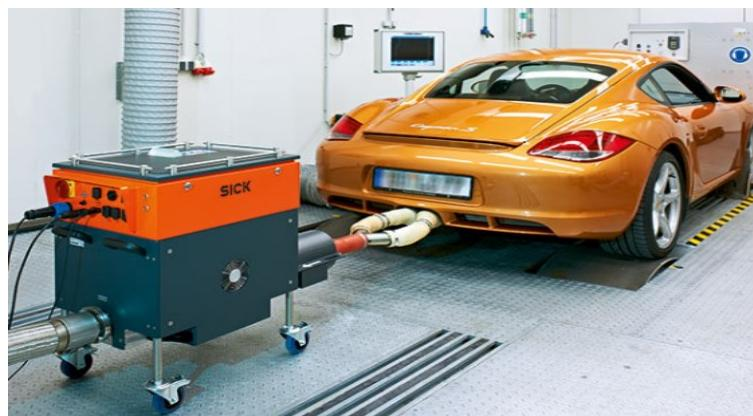
Slika 7. Automobil prikopčan na SICKov ultrazvučni plinski mjereni uređaj Flowsik150 Carflow
