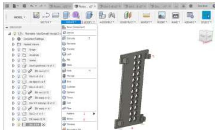
**Slika 43.** Kreiranje otvora za hlađenje, te pričvršćivača
