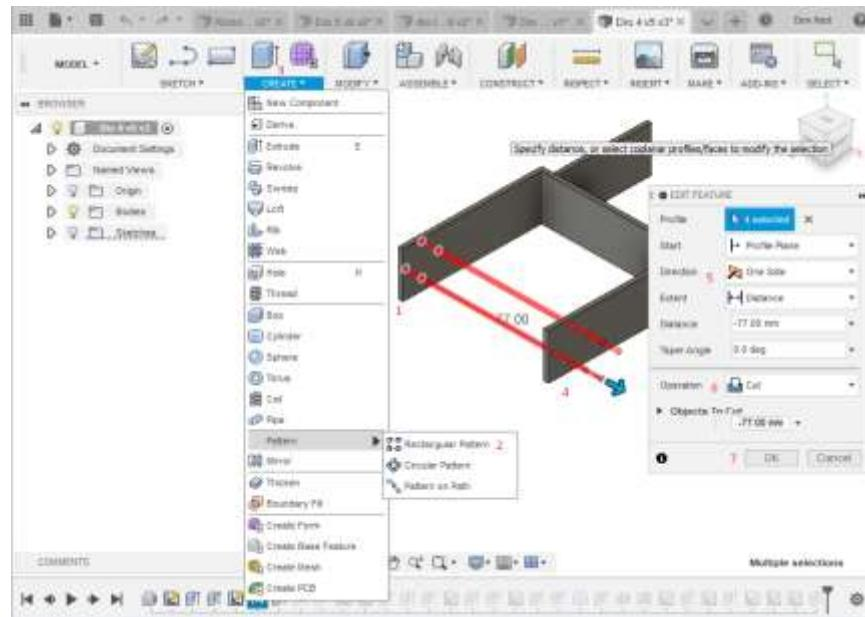
Slika 30. Kreiranje utora za pričvršćivanje dijelova robotske ruke
