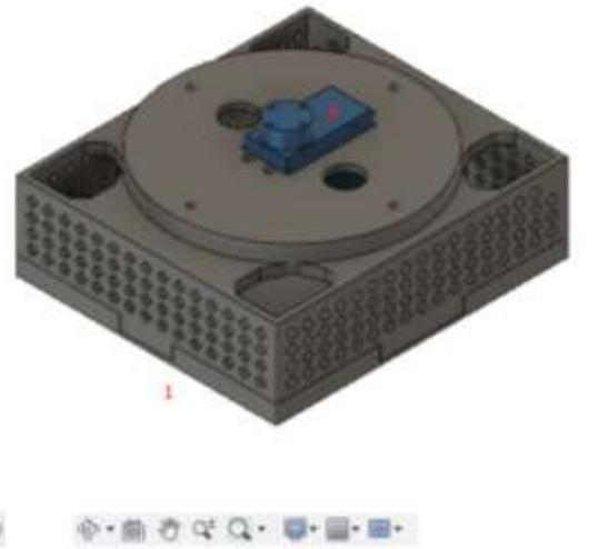
Slika 18. Prikaz završene baze robotske ruke
