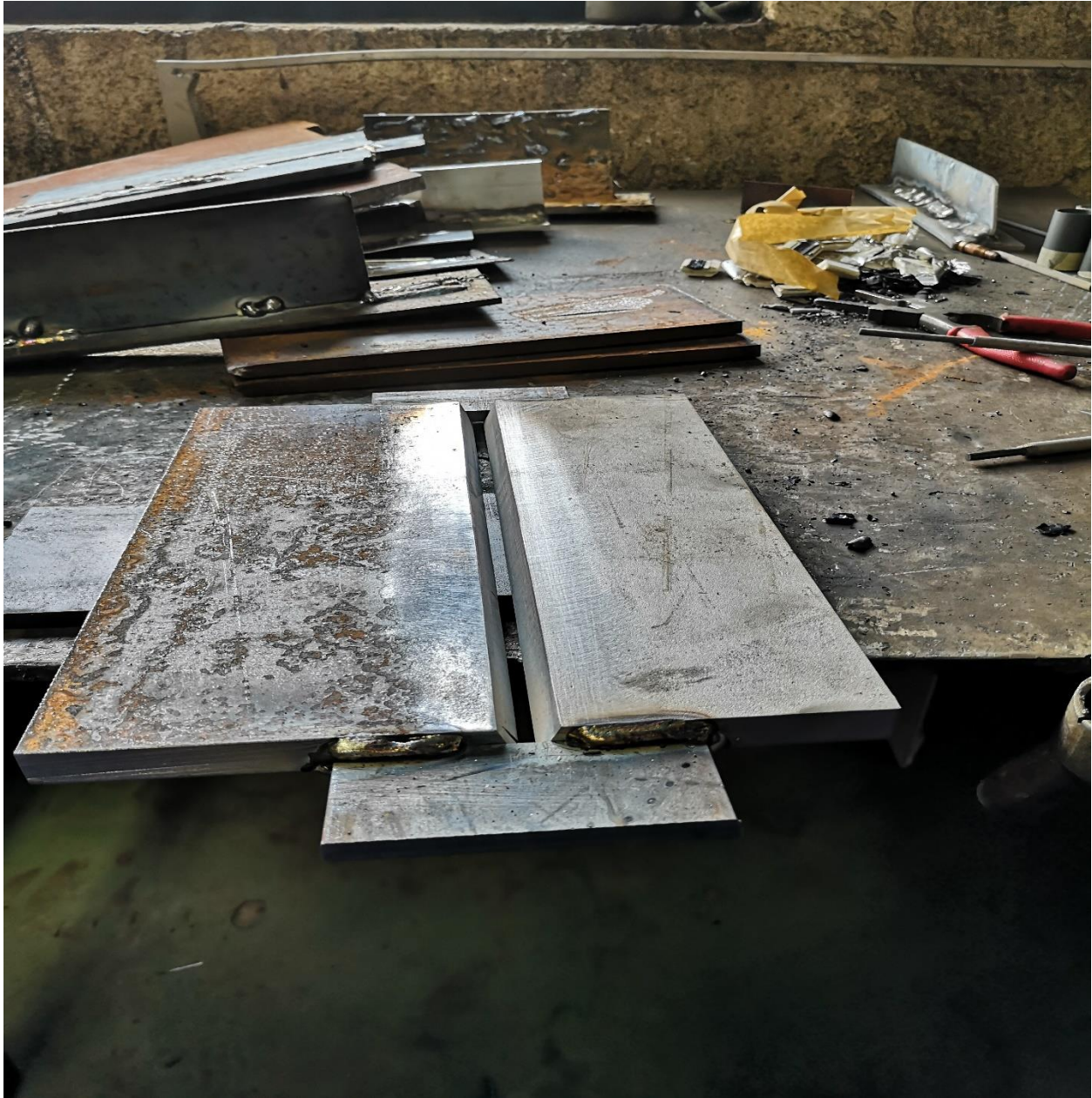
Slika 6 Pripremljeni "V" spoj
