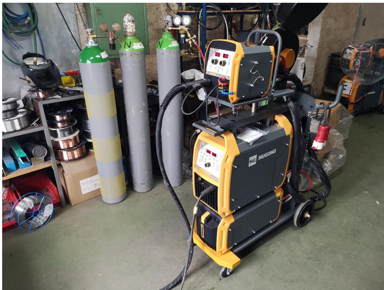
Slika 2 Aparat za MAG zavarivanje
