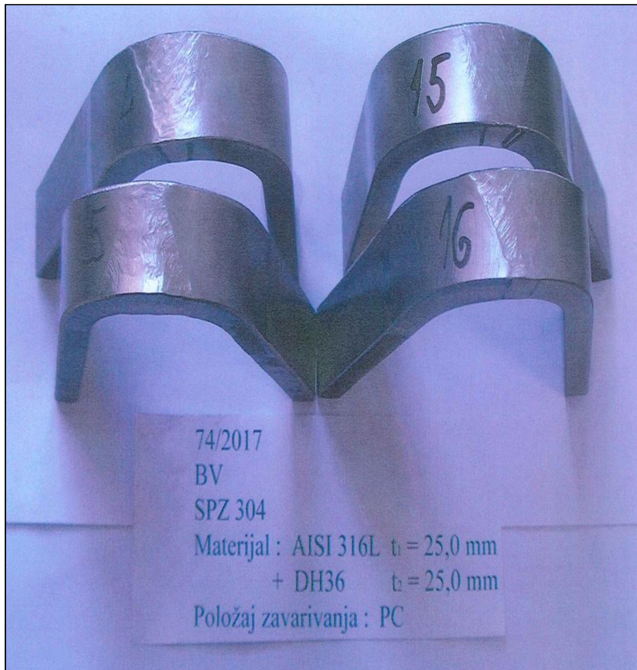
Slika 27 Epruvete nakon ispitivanja savijanjem
