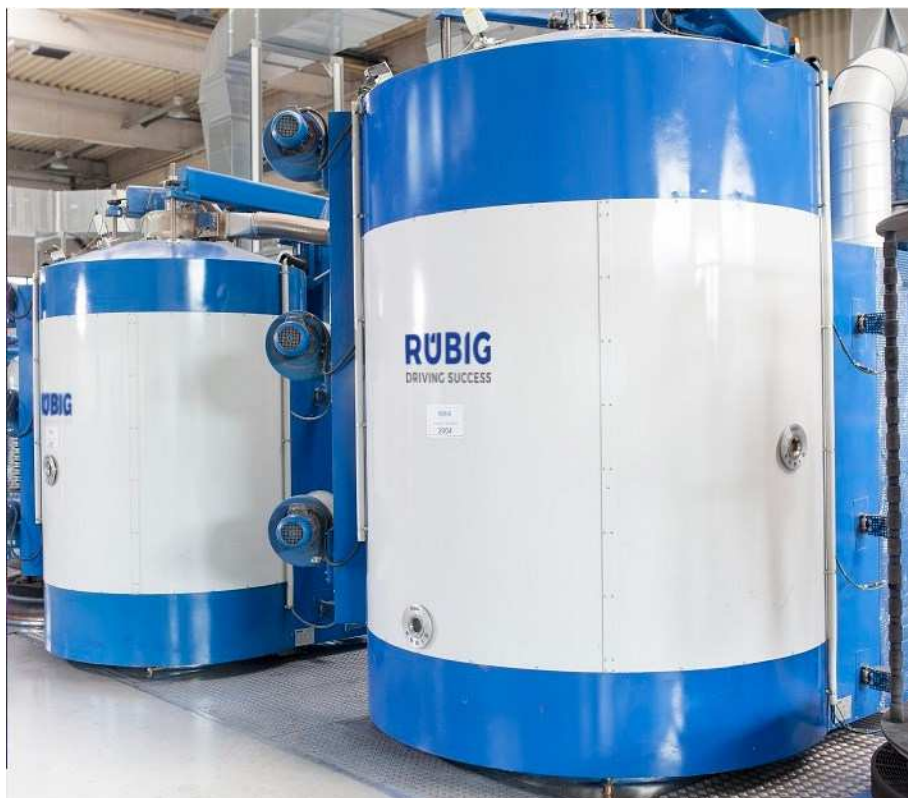
Slika 8. Vakuumska komora za postupak PLASOX [14]
