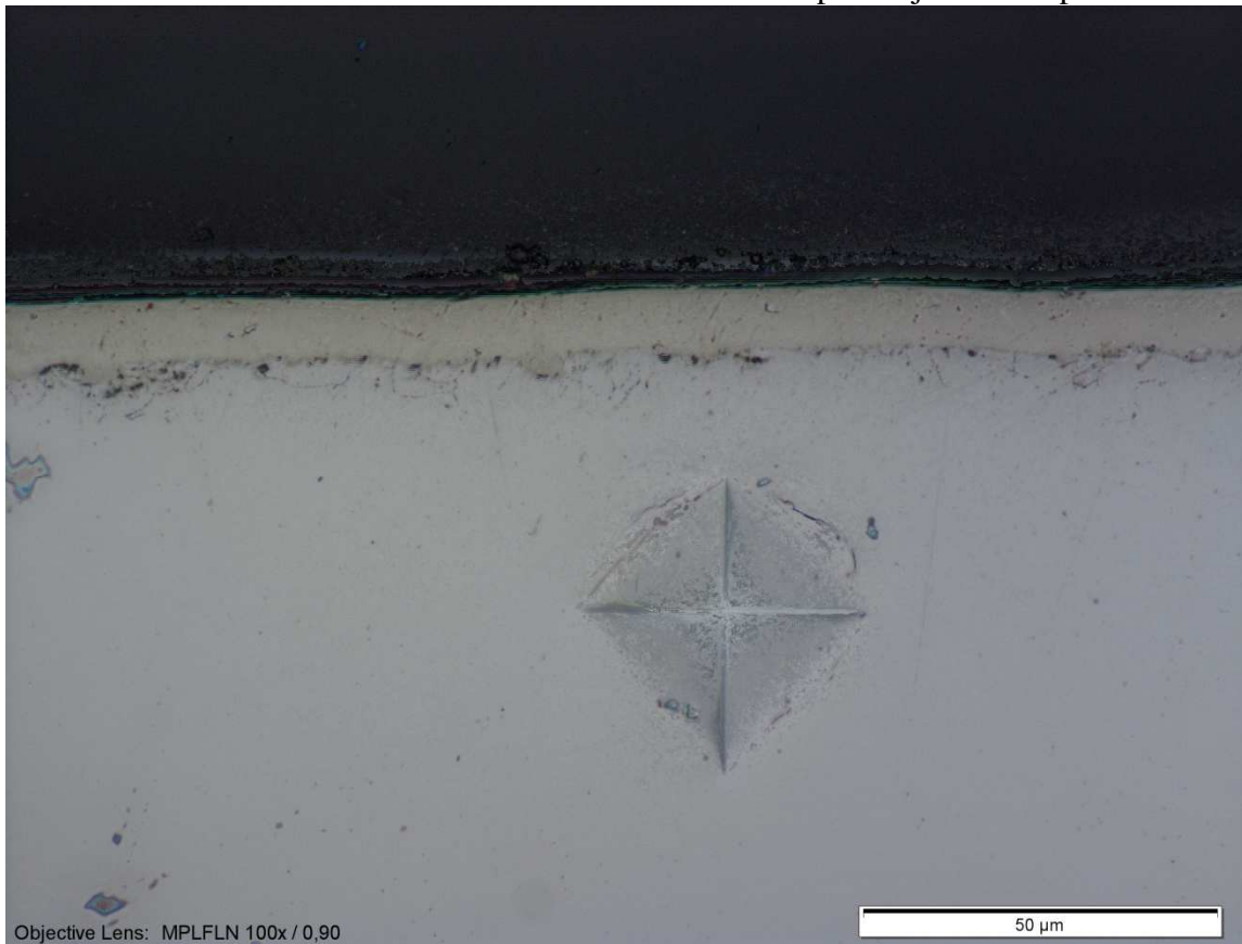
Slika 12. Difuzijska zona i zona spojeva snimljena na uzorku optičkim metalografskim mikroskopom Olympus BX51 u laboratoriju METRIS
